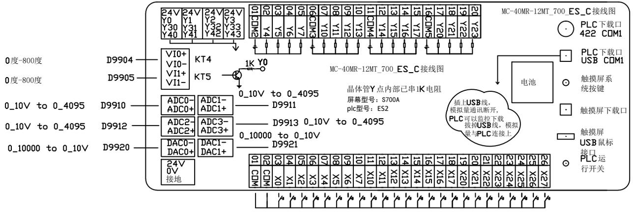
输入属于NPN型, 不需要外接电源, 直接短接COM和X点即可
